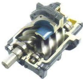
ลูกปืนทุกด้วยที่ใช้จะมีการลึกกว่าอนหารือแตกได้ อันเนื่องมาจากสิ่งสกปรกที่ปนเปื้อนเข้าไปในชุดอัดลมในช่วงของการดูดอากาศเข้า การกลับตัวเป็นน้ำในช่วงของการอัดอากาศ การเกิดปฏิกิริยาความดันของออกซิเจนและการเกิดเขม่าของน้ำมันหล่อลื่น การลึกกว่าอนหานจะเกิดขึ้นที่ละน้อย ซึ่งจะทำให้ระยะห่างระหว่างโรเตอร์กับเลือดของโรเตอร์มีค่าเพิ่มขึ้น เป็นเหตุให้ประสิทธิภาพในการอัดลมลดลง
